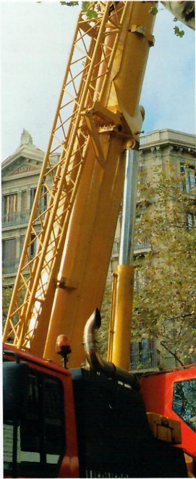
A toronydaru részegységeinek felemeléséhez nagy teljesítményű hidraulikus emelő szükséges (a sárga cső az acélhengerrel), melynek működése Pascal törvényén alapszik.
