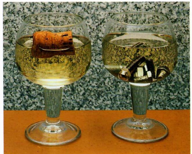
A pohárban lévő szilárd test térfogata ugyanakkora, mint a túlsorduló folyadéké. A testre ható felhajtóerő megegyezik a kiszorított folyadék súlyával.
